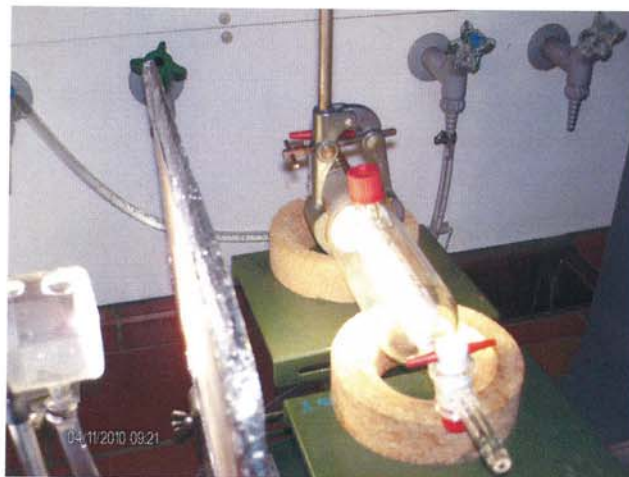
Abb. 1: Photoreaktor mit Wasserfilter zur Entfernung von IR-Strahlung (Mitte). Links davon befindet sich die nicht sichtbare Lampe.
